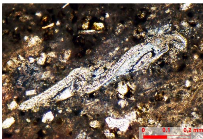
Foto 45 - Cumeeira refeitório Coberta. Fibra de celulose. Notar abundância de pontinhos marrons avermelhados, sendo fases ferríferas hidratadas. Fibras diferenciam-se da crisotila pela forma e birrefringência. Polarizadores paralelos.
