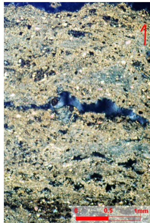
Foto 49 - Crespum Coberta. Telha muito carbonatada (homogênea) e porosa. Deterioração avançada. Polarizadores cruzados.
