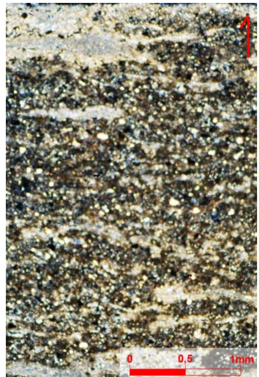
Foto 82 - Muller Descoberta. Perfil do topo: telha pouco carbonatada, superfície plana. Pequenas faixas microporosas. Polarizadores cruzados.
