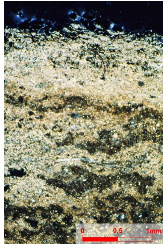
Foto 68 - Embalagens - Phebo Descoberta. Perfil do topo: Sujeira penetrando na telha, abundância de vazios irregulares, telha pobre em fibra, pouco clínquer residual. Polarizadores cruzados.
