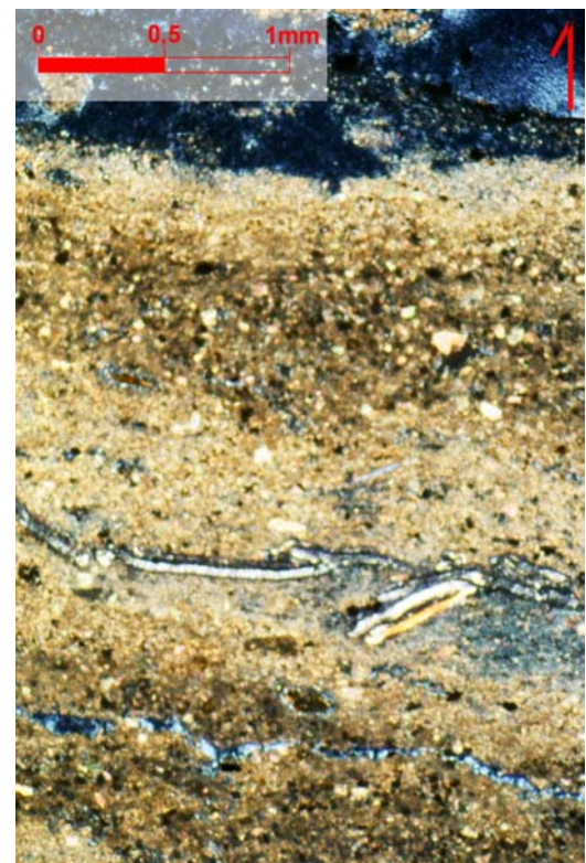
Foto 35 - Crespum Descoberta. Perfil de alteração do topo. Zona de corrosão e zona carbonatada. Fibra de celulose e fissura "alargada" por dissolução, com paredes irregulares, paralelas à superfície. Polarizadores cruzados.
