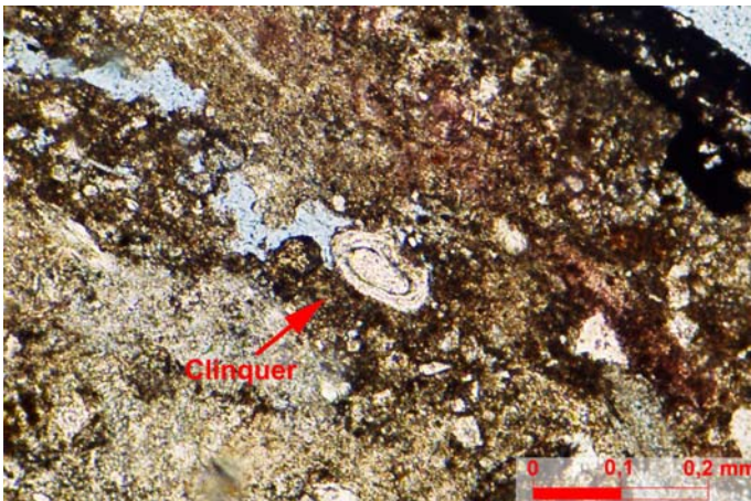
Foto 59 - Pavilhão Phebo Coberta. Grão de clínquer com halo estratificado de gel parcialmente carbonatado. Polarizadores paralelos.
