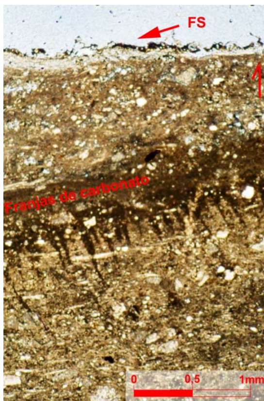
Foto 62 - Pavilhão Phebo Descoberta. Perfil da BASE: Filme, corrosão e lixiviação 1: "raízes" de carbonato escuro (impregnado ou mais fino?) penetrando na zona já carbonatada. Polarizadores paralelos.
