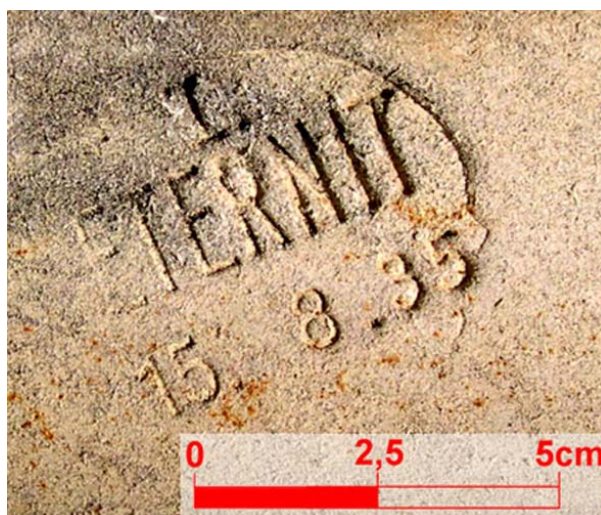
Foto 44 – Detalhe do relevo na amostra LPTR 750/05, indicando a data de fabricação da telha (15.08.1935) e o fabricante.
