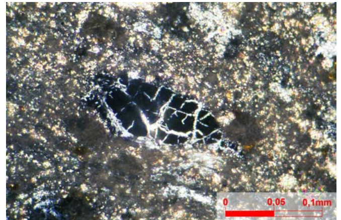
Foto 58 - Pavilhão Phebo Coberta. Grão de vidro. Fraturas típicas de vidro, com material birrefringente. Polarizadores cruzados.
